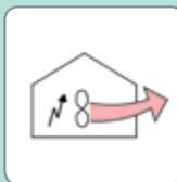
Применяется для механического сброса давления в секции рециркуляционного воздуха и обеспечения притока наружного воздуха в агрегатах с экономайзером или заслонкой с приводом. Вентилятор работает при условии достаточного притока наружного воздуха и допустимой температуре наружного воздуха (+12 °C...+30 °C).
