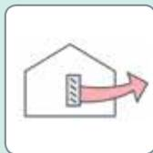
Используется для снижения внутреннего давления в агрегатах, оснащенных экономайзером или заслонкой с приводом, но без вентилятора форсированного сброса давления. При работе крышного кондиционера в режиме охлаждения наружным воздухом или подачи наружного воздуха, заслонка открывается, что снижает давление в секции рециркуляции. Заслонка поставляется в сборе; она комплектуется крышкой для защиты от осадков и защитной решеткой.
